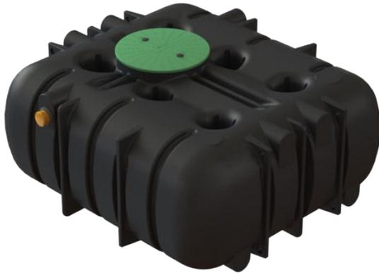
Robust, lågbyggd slamavskiljare med stor slamlagringskapacitet utrustad med 3- kammare som ger extra lång sedimenteringssträcka och optimal reningsgrad. Mycket hög slamavskiljningsförmåga (0,06g). Flexibel design som passar olika förhållanden för nedgrävningsdjup och möjlighet att placera inlopp/utlopp på både kortsidor och långsidor.
