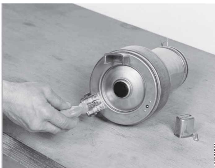
Figur 10: Avlägsnande av pumpfötter
