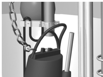
Fig. 15 Kätting fäst på pumpen
