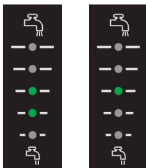
Fig. 14 Indikering av utloppstryck på SCALA2
