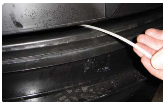
Använd buntband för att undvika luftfickor
