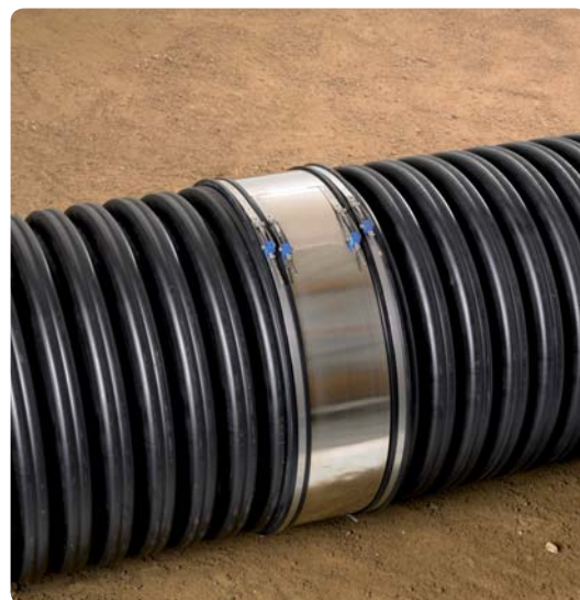
4. För bästa resultat skall kopplingen dras med följande moment: Dimension 800 och 1000 20 Nm. Dimension 1200 Nm 25.
