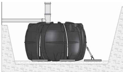
Förankring med förankringsplattor.
