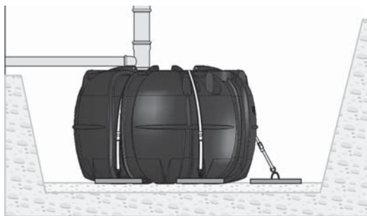
Föranckring med föranckningsplattor.
