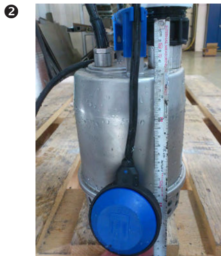
2 Vippans styrkabel ska vara 150 mm lång från pump till underkant flottör.
