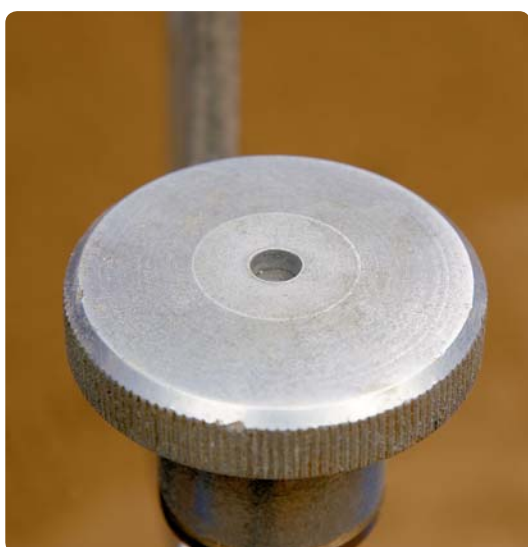
6. Hållverkyget ska spännas så mycket att skruven i mitten är jäms med ytan.
