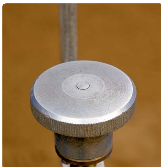
6. Hållverkyget ska spännas så mycket att skruven i mitten är jäms med ytan.
