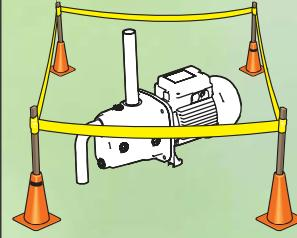
**IT** - I motori monofase sono muniti di protezione termo amperometrica: si collegano direttamente alla rete di alimentazione.
