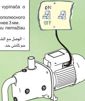
**IT** - Collegarsi alla rete tramite un interruttore onnipolare con distanza dai contatti di almeno 3 mm.
