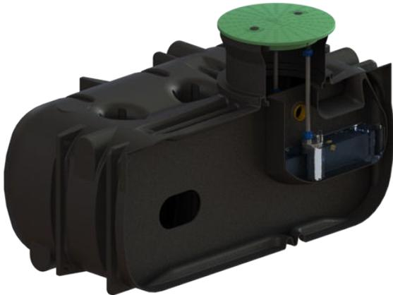
Robust, lågbyggd slamavskiljare med stor slamlagringskapacitet utrustad med 3 kammare samt integrerad pumpbrunn som ger extra lång sedimenteringssträcka och optimal reningsgrad. Mycket hög slamavskiljningsförmåga (0,06g). Flexibel design som passar olika förhållanden för nedgrävningsdjup och möjlighet att placera inlopp/utlopp på både kortsidor och långsidor.
