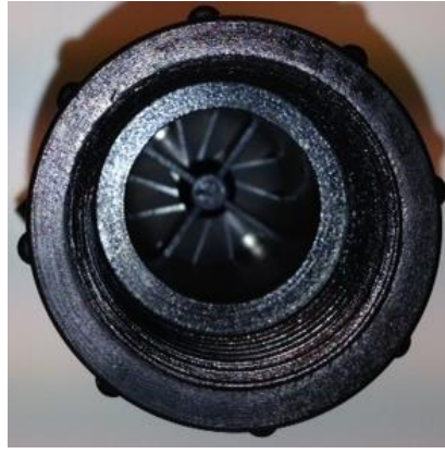
Utlopp med vattenmätare
