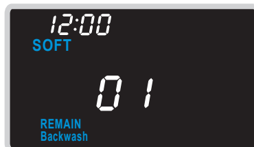
Backwash (backspolar filtret).
